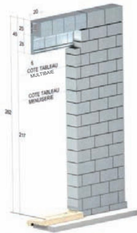
\* Cote tableau au niveau du linteau MULTIBAIE = Cote tableau menuiserie + 1 bloc multibaie (soit 20 cm répartis en 10 cm de chaque côté)
