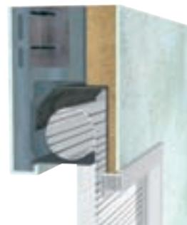
avec caisson de volet roulant ouvert (parachèvement sur chantier)
